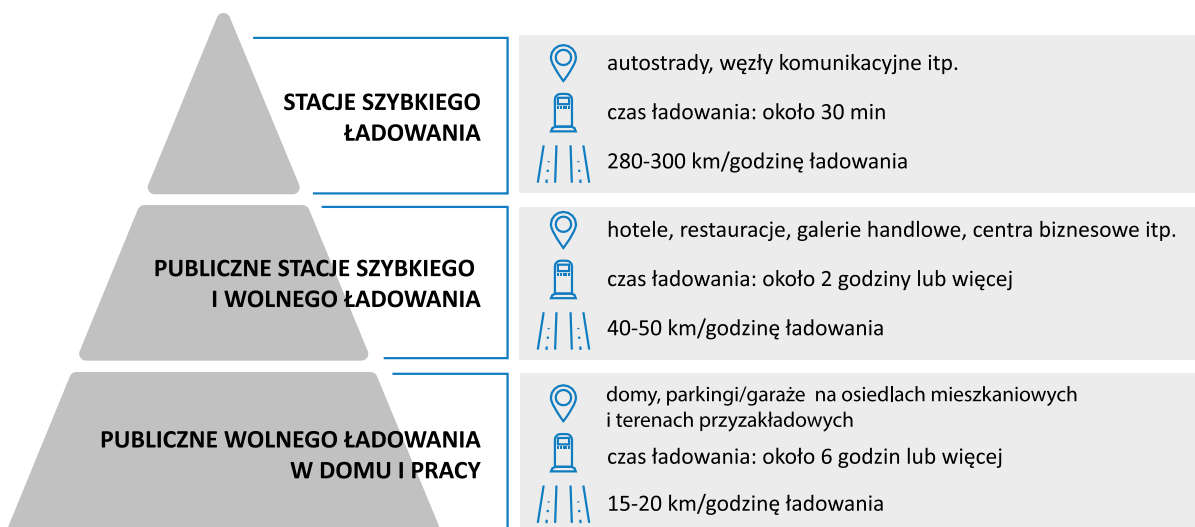
Rysunek 16: Mix infrastruktury ładowania pojazdów elektrycznych
