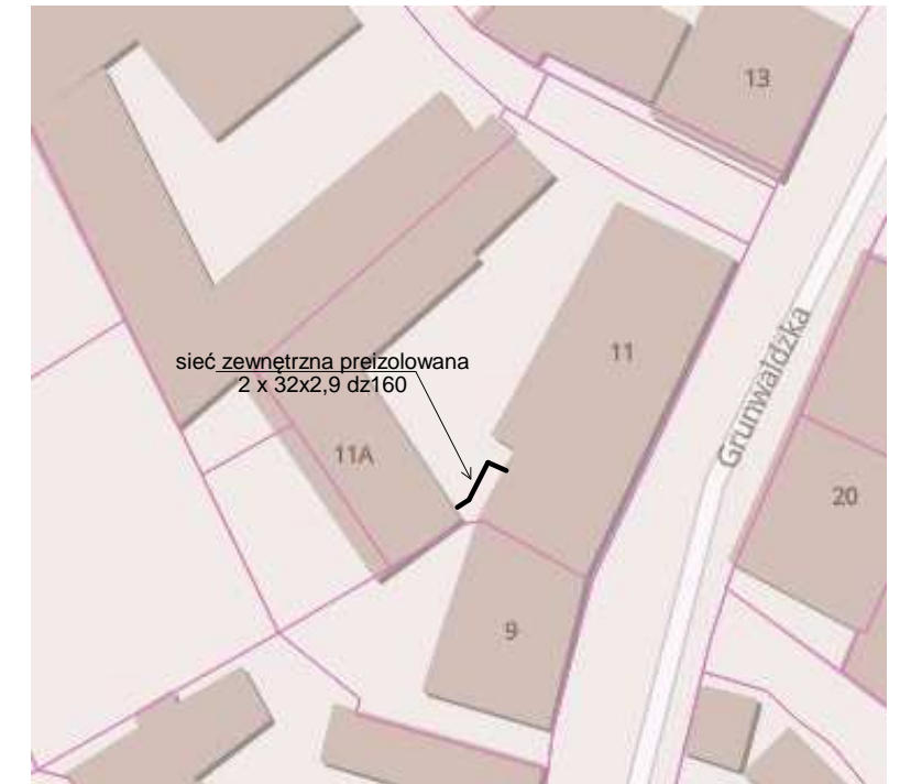
Poglądowy przebieg sieci preizolowanej w terenie
