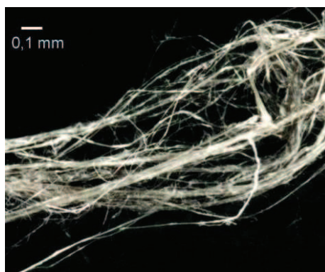
Rys. 1. Długo włóknisty azbest chryzotylowy praktycznie niezawierający zanieczyszczeń (Chiny)
